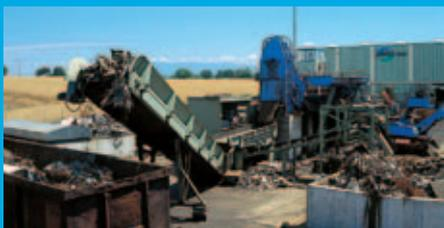
Abbé SA a Satigny/GE: cesoia idraulica di 800 to. con selezionatore vibrante
