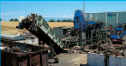
Abbé SA à Satigny/GE: cisaille hydraulique de 800 tonnes et table de triage vibrante
