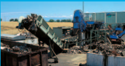
Abbé AG in Satigny/GE: 800 Tonnen starke hydraulische Schrottschere und vibrierende Sortiertafel
