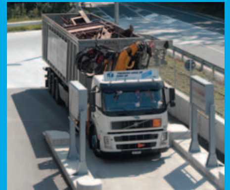
Die neue Sicherheitsschleuse für die Detektion von radioaktivem Material
